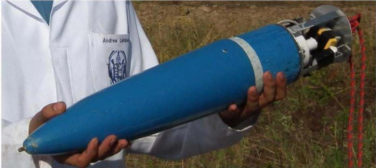
Foto 7. Carga útil colocada en la nariz de un cohete ULA-1, recuperada con éxito luego de la prueba dinámica llevada a cabo el 26 de Noviembre de 2011.
